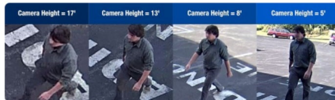
Effet de la hauteur de la caméra sur la qualité de l'image 29 (avec l'aimable autorisation d'IPVM)
